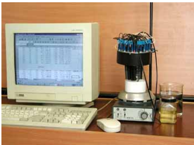
Лабораторный вариант электронного языка с потенциометрическими химическими сенсорами
